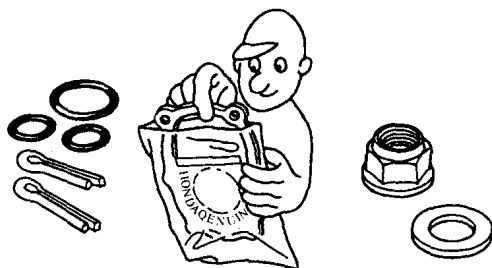
图 1-16 重新组装时应使用新的 填料、垫片、O形密封圈和开口销
