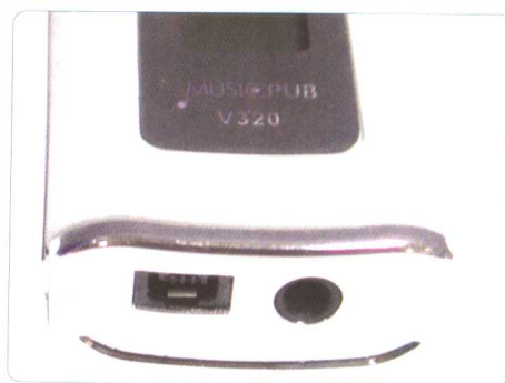
方正 V320 上的 USB 口和耳机接口
