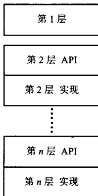
图 1-5 软件层向上公开接口，封装实现细节
