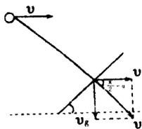
【解析】 (由图可知:  $\frac{V}{V_x} = \text{tg}\alpha$ ;  $V_x = \frac{V}{\text{tg}\alpha}$  又知  $V_x = gt$ ;  $gt = \frac{V}{\text{tg}\alpha}$  所以  $V$  不变  $\alpha \uparrow t \downarrow$ ;  $\alpha$  不变  $V \uparrow t \uparrow$ .)
