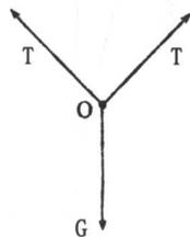
$$\alpha = \arcsin \frac{G}{2T} \text{ 当 } \alpha \geq \arcsin \frac{G}{2T} \text{ 时钢丝绳不会断}$$
