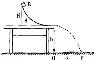
(2) 斜面高度  $H$ , 桌面到地面的高度  $h$ ,  $O$  到  $P$  的距离  $s$ , 小铁块  $B$  的质量  $m$ .
