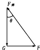
需要强调的是重力是不变的, 拉力 F 的方向不变, 由此可得弹簧的拉力  $F_{\text{弹}} = G / \cos \theta$ , 由胡克定律知  $F_{\text{弹}} = kx$ , 即能够得到  $x = G / k \cos \theta$ , 由余弦函数的规律可以判断出 D 是正确的.
