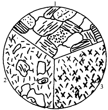
图 2-3 岩浆岩的三种结构 1—全晶质结构; 2—半晶质结构; 3—非晶质结构(玻璃质结构)
