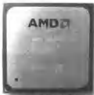
◆加了盖的处理器表面上更易于安装散热器, 但让做假者有机可乘。
