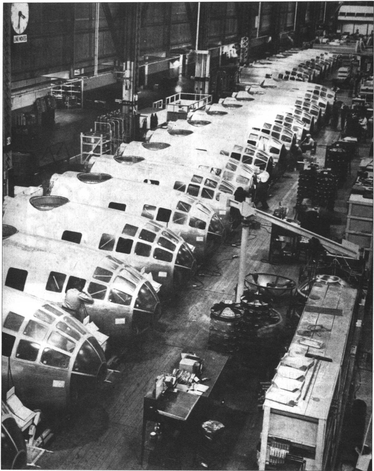
在波音公司西雅图的装配线上,工人们把鼻锥体拴在B-29的前部,这种鼻锥体由不易碎的抗压有机玻璃制成。
