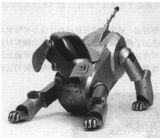
图 1-5 Sony 的 Aibo ERS-110 机器狗使用一个 MIRS 64 位 RISC 处理器（Sony 电子公司惠许）
