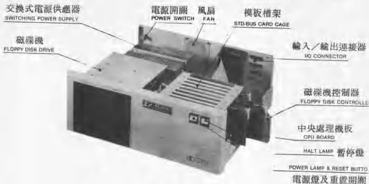
圖 1 - 2 PA 2000 內部構造
