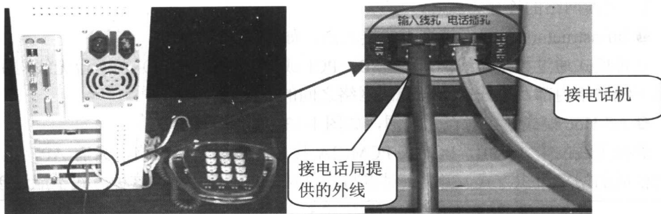
图 1-15 拨号上网调制解调器与电话线的连接
