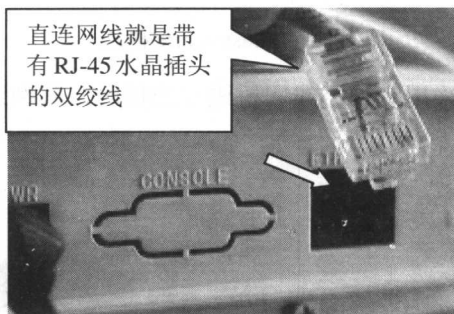
图 1-17 另一端插入 ETHERNET 插口
