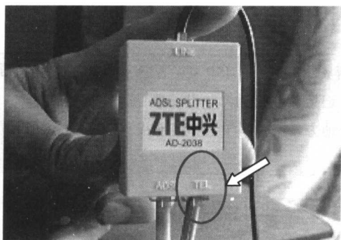
图 1-20 将水晶插头插入 TEL 插口中
