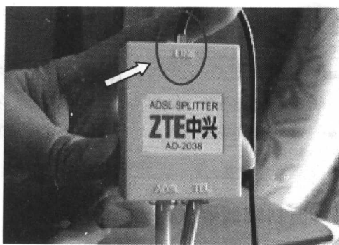
图 1-21 电话外线插入分离器的 LINE 插口中
