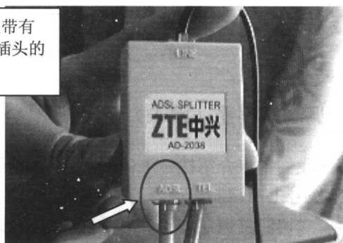
图 1-19 另一端插入分离器的 ADSL 插口中
