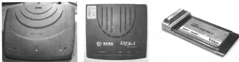
图 1-3 用于 ADSL 的调制解调器 (左、中) 和用于笔记本电脑的无线 Modem (右)
