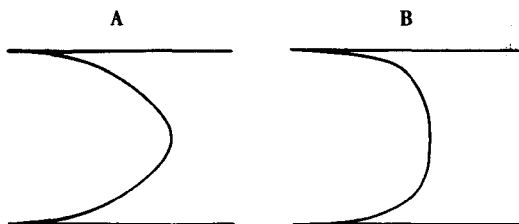
图1-1 正常动脉管腔内的速度轮廓。A,层流,抛物线型。B,中心流速相对一致,扁平型轮廓线,常见于动脉分叉近段和湍流状态。
