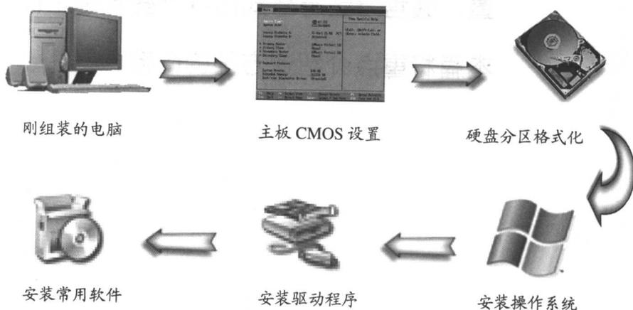
上面的流程示意图基本上将电脑组装后所需要操作的过程描绘完整，其中主板 CMOS 设置和硬盘分区格式化是安装操作系统的准备工作，而安装驱动程序则是辅助工作。我们只要按照流程图一步一步地进行，就可以轻松地将系统安装完成。
