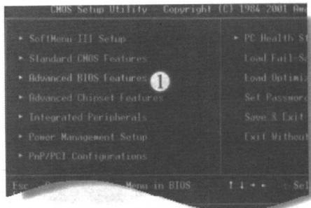
**步骤2** 按 Enter 键进入“First Boot Device”设置窗口，如下图所示。
