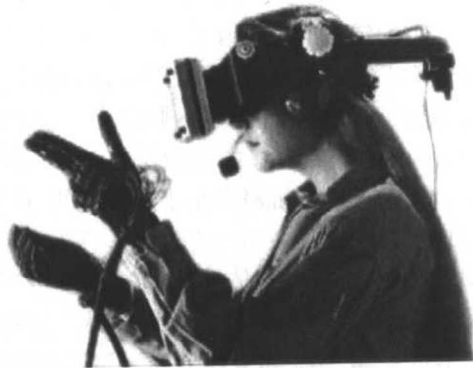
图 1-5 基于头盔式显示器的典型虚拟现实系统
