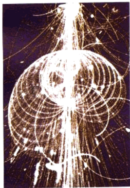
▲當原子核以非常高的速度相碰撞時，即短暫地重新創造出最初微秒期間發生在原始宇宙裏的狀況。此幅攝自歐洲共同原子核研究所(CERN)的超級質子同步加速器(SPS, Super Proton Synchrotron)的照片，顯示出當硫原子核正對著一個鉛靶撞擊時，所留下之次原子核殘餘物的軌跡。在碰撞當時所釋放出來的能量是如此地高，以致於個別的原子核粒子會消失，即形成一個飛跑中的夸克火球。這些火球接著再重新結合成由高速運動的質子與其他次原子核粒子組成的噴射流。
