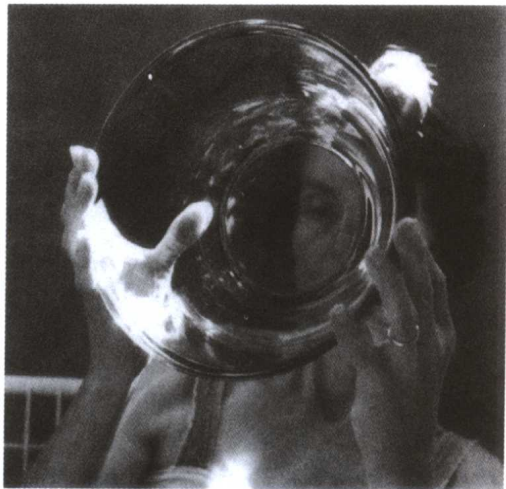
图 3-6 使用颜色、透明度以及密度等物理性能对玻璃产品进行光学检查
