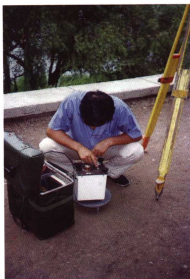
照片10 高精度重力探测野外施工
