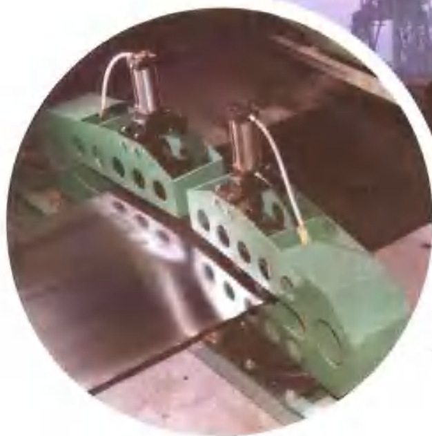
科技人员研制的 APC 八字辊带材纠偏装置
