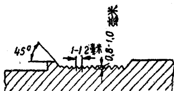
圖 7 噴鍍前零件表面的準備工作圖
