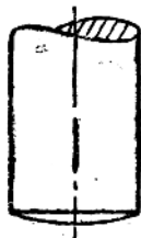
圖16 製造得不正確的 凸模。
