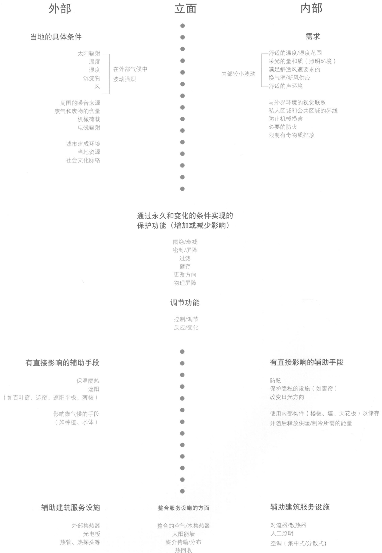
图A 1.1 立面内部及外部的需求；保护、调节和沟通功能；附属被动手段及建筑服务设施
