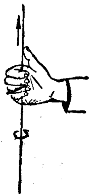
圖 4 用右手表明電流及磁力綫的方向
