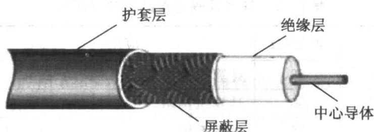
图 1-6 同轴电缆的结构示意图
