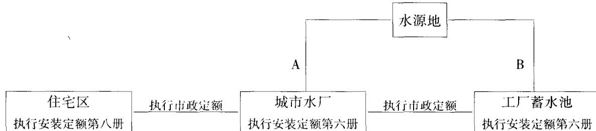
说明:A、B 为水源管道,一般有两种情况,当水源地至城市水厂(或工厂蓄水池)的管线在市区时,执行市政定额;管线不在市区时,且厂外距离在 10km 以内时,执行安装定额工业管道工程定额,厂外距离在 10km 以外时,执行安装定额长距离输送管道工程定额。
