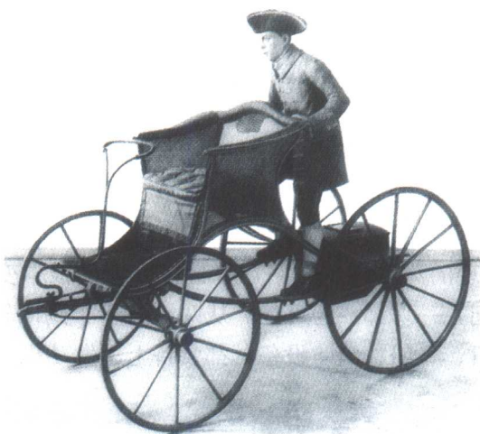
图2 人力动力车（1765年） 该4轮人力车使用踏板驱动，带动左后轮。
