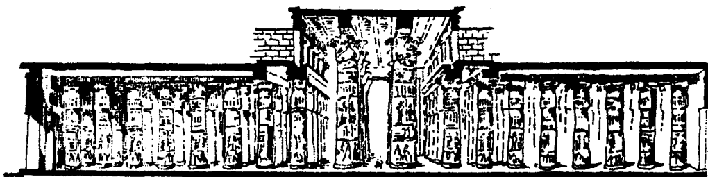
图 1-3 古埃及太阳神庙柱厅剖面
