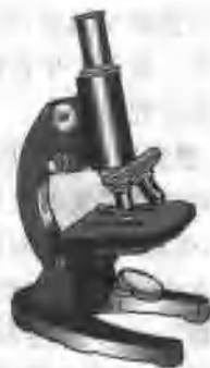
图 1.3 单筒式光学显微镜
