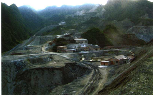
照片13 陕西宁强石棉矿露天剥采导致水土流失严重
