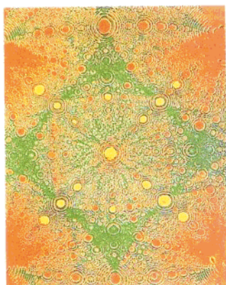
图 1-4 场离子显微镜(FIM)拍摄的图像显示了铂针顶端的原子排列顺序(橘黄色),这个图像放大了 200 000 倍
