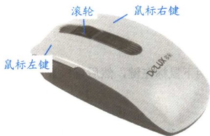
图 1-2 常用的光电 3D 鼠标
