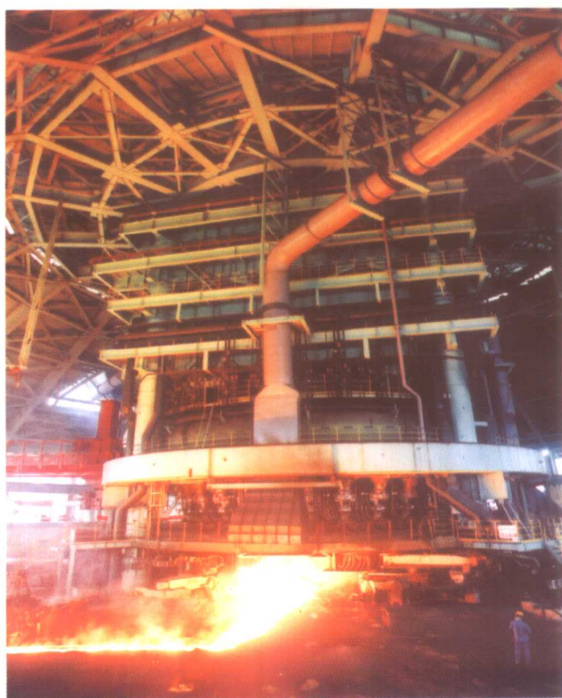
6号高炉出铁现场
