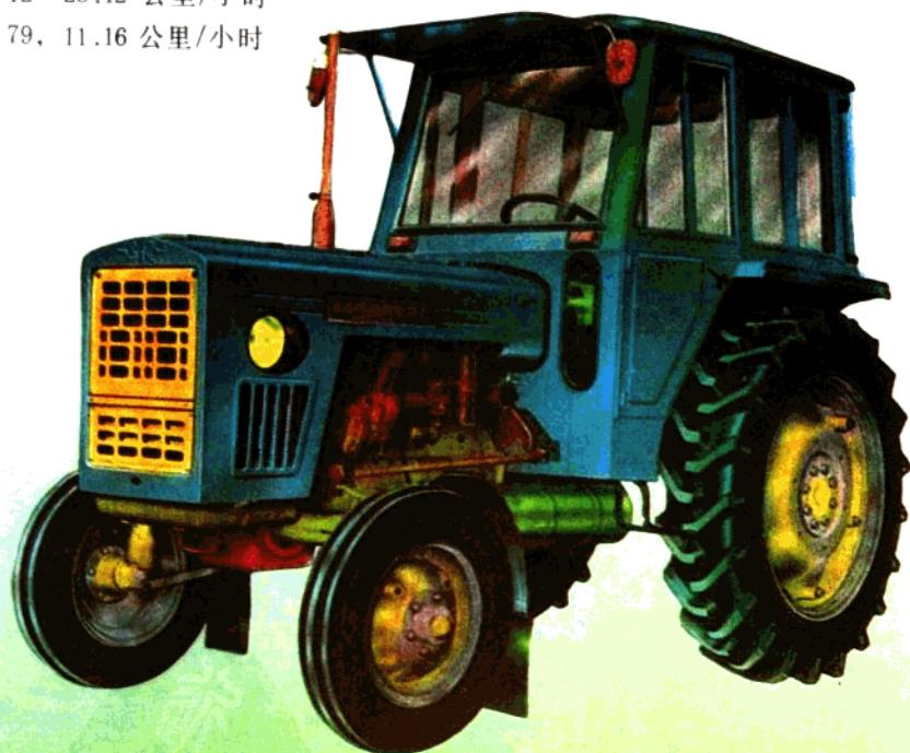
本拖拉机单位马力比重量小, 重量分配恰当, 速度搭配合理, 转向灵活, 操纵轻便, 行驶安全舒适。适用于水田和旱田的耕、耙、播、收及运输、铲运、平整土地等各种作业。
