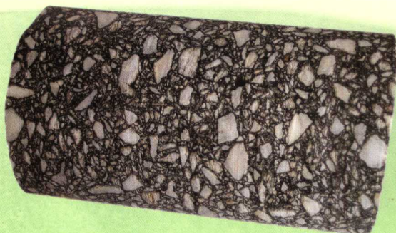
● 沥青混凝土芯样
