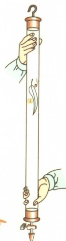
图4 真空玻璃管内的鸡毛、铜钱同时下落
