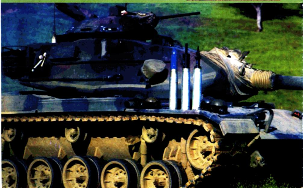
装有1挺12.7mm M85式高射机枪。机枪能够随指挥塔一起旋转，俯仰范围为-15°~+60°可对空射击低空飞行的直升机或打击地面目标，车长在指挥塔内瞄准和射击。主炮左侧安装1挺7.62mm M73式并列机枪，1978年已改装M240式机枪，用M13型100发的金属弹链供弹。1977年M60A1坦克加装了M239型烟幕弹-榴弹发射器，炮塔两侧各6个。
