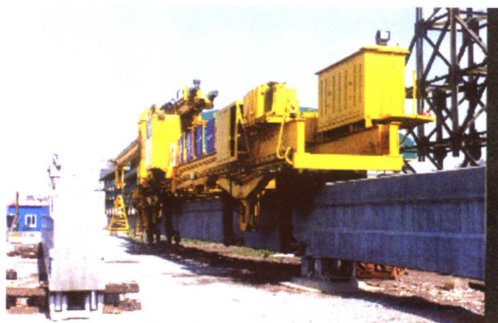
轨道梁架桥机
