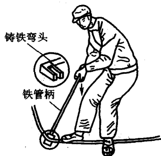
图 1-18 用管弯管器弯管
