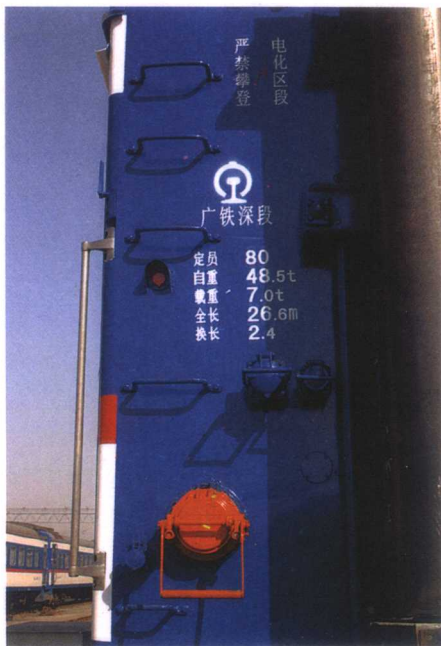
图1-5 客车车辆总重量及换算长度标记图例
