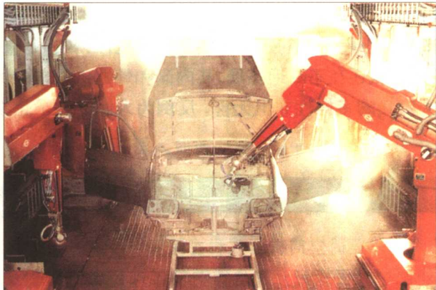
图1.1 机器人在为汽车喷漆
