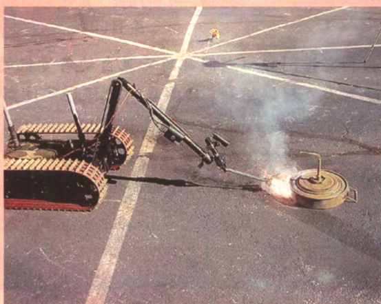
(a)军用防爆机器人在处理爆炸物
