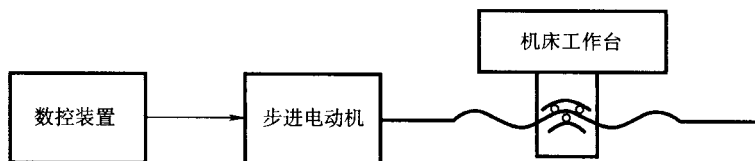
图 1-4 开环控制数控机床
