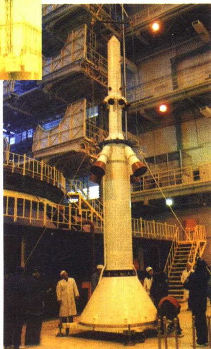
彩图5 ▶ 中国神舟号试验飞船逃逸系统
