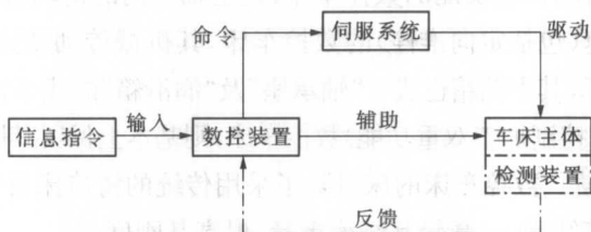
图 1-4 数控车床的基本组成方框示意图
