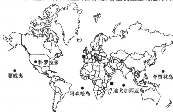
图 1.5 GPS 的地面监控部分
