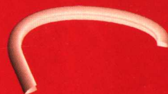
使用“沿曲面”模式的“逼近”延伸模式创建曲面
