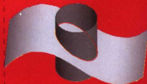
使用曲面相交求两曲面的交线
