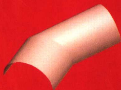
使用“至平面”曲面延伸创建曲面
