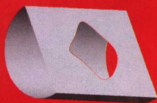
使用曲线修剪曲面组创建曲面
