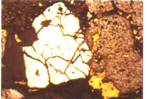
照片 6 磁铁矿中黄铁矿呈磁铁矿假像, 黄铜矿产于二者的裂隙中(矿显微镜, 一, \times 75 )
