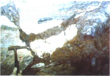
照片 3 控矿(II号矿体)主断裂在边部形成不规则含矿支裂隙, 扩容特征明显
