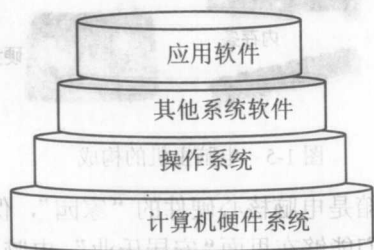
图 1-3 硬件系统与软件系统的关系层次
