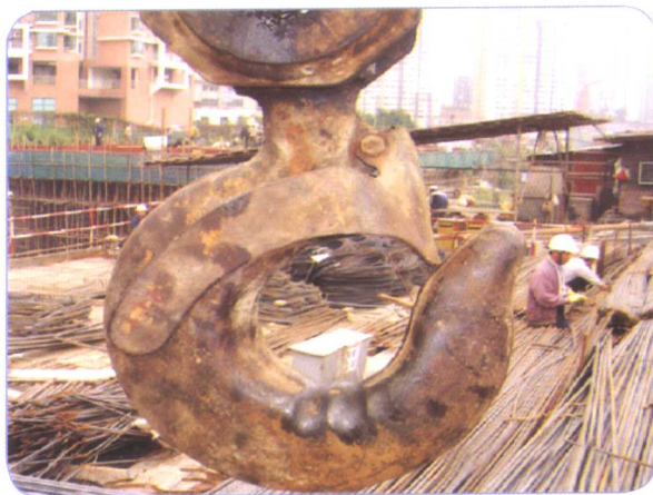
吊钩危险断面磨损
