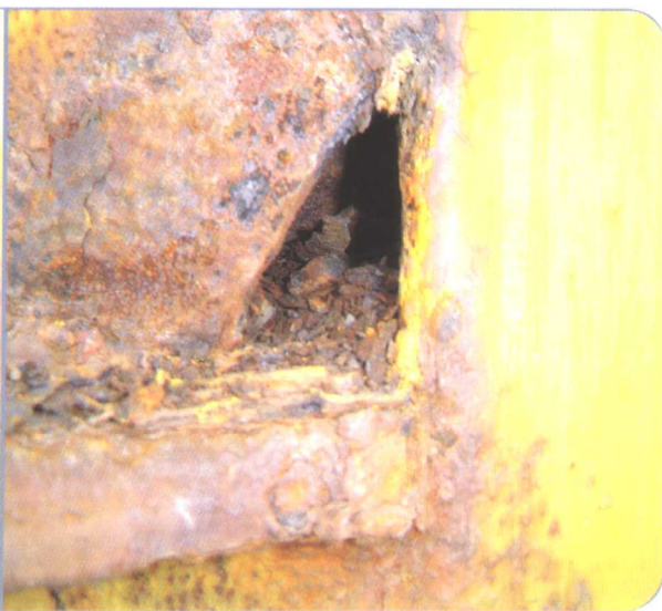
塔机下回转金属结构锈蚀严重
