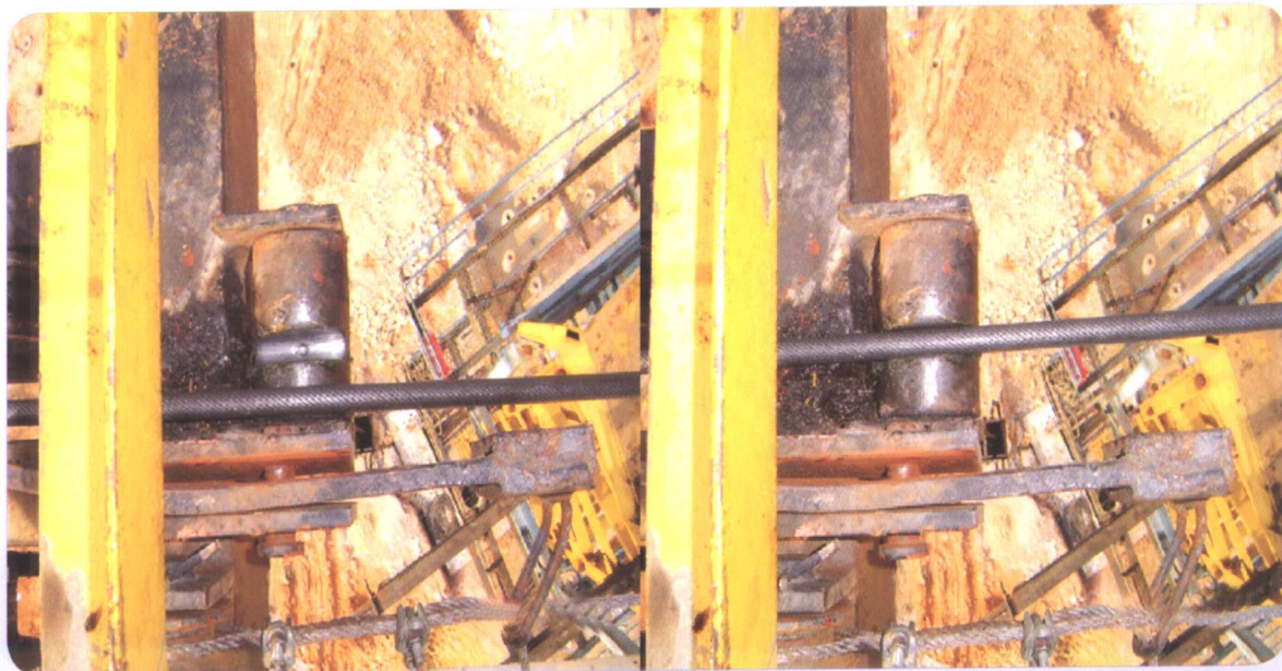
托轮不转动被往复运动的钢丝绳磨损
