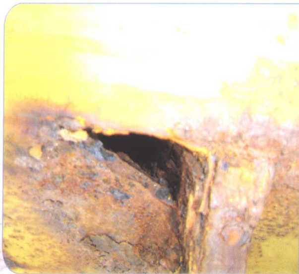
塔机下回转金属结构锈蚀严重
