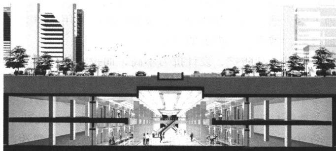
图 1-1 某平战结合人防工程剖断示意图
