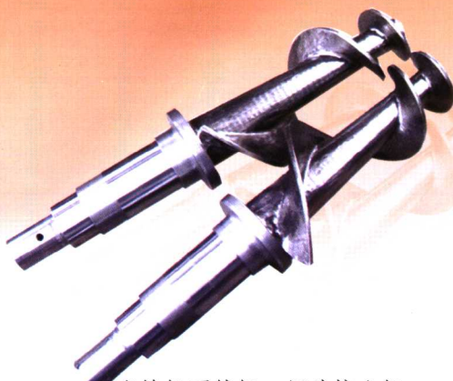
密炼机下辅机、压片挤出机 \Phi 936 特大型双锥双金属螺杆
