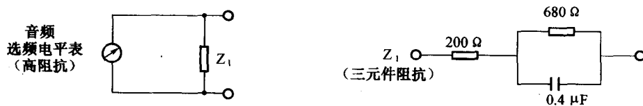
图 1-3 二线模拟用户接口三元件电平表组成图
