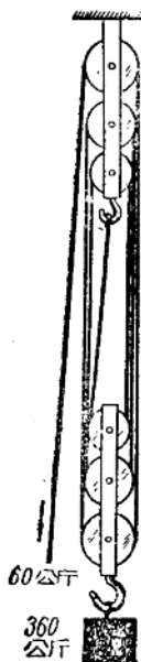
圖 8. 滑輪組 的工作原理
